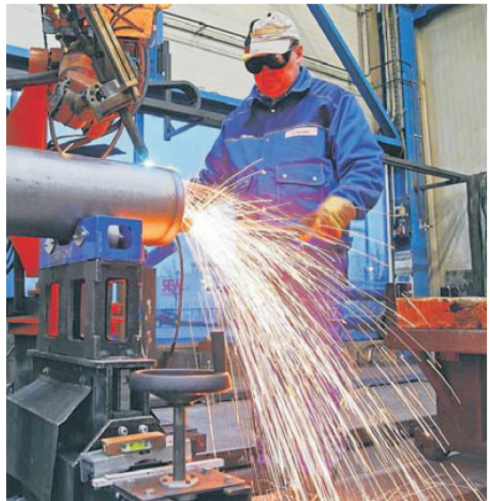
Mitarbeiter Uwe Steiner beim autogenen Brennschneiden eines Rohres im Meeraner Unternehmen ZIS Industrietechnik.
